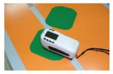
Проверка разнооттеночности покрытия.
