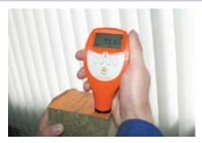
Проверка толщины покрытия.
