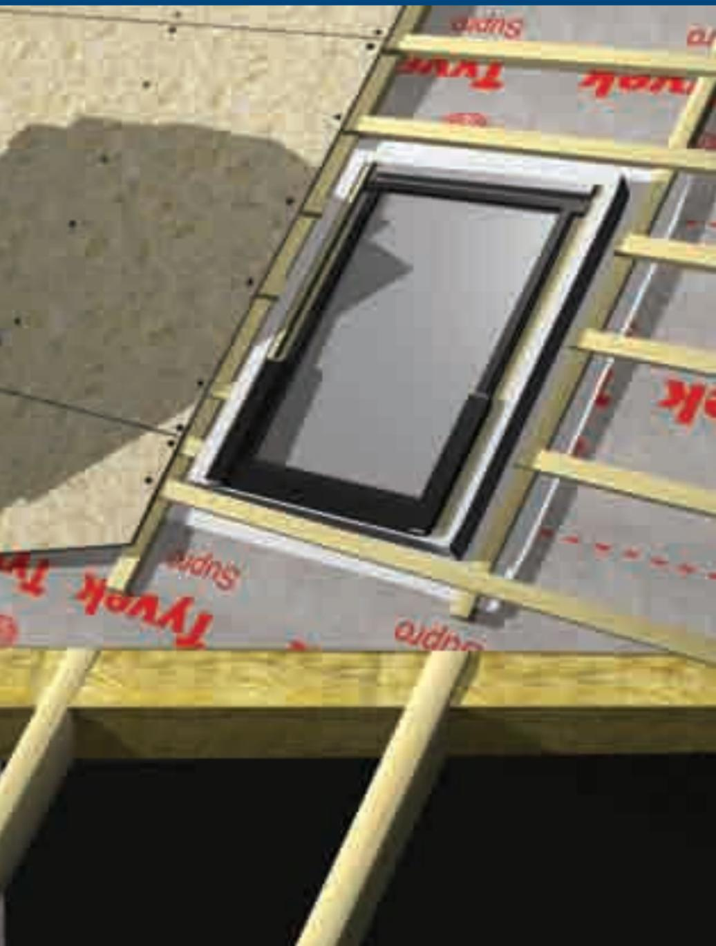
Для нормального функционирования кровли необходимо обеспечить надлежащую вентиляцию. Ширина вентиляционного зазора над материалами Tyvek® должна быть не менее 50 мм.
