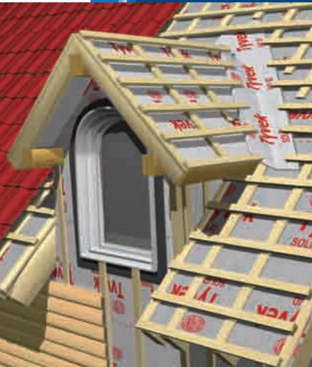
**Рис. 1 Устройство утепленной мансарды**
