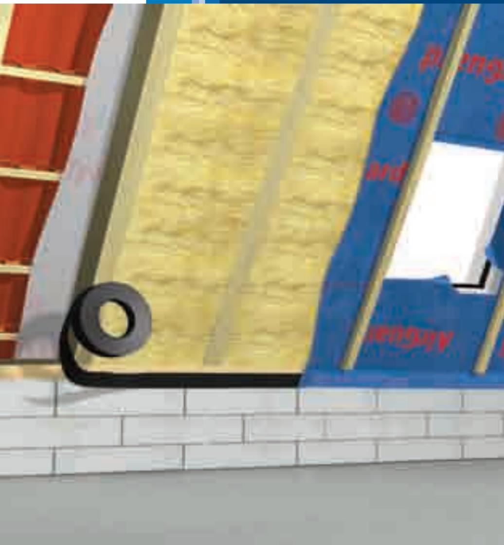
**Рис. 10** Монтаж пароизоляции
