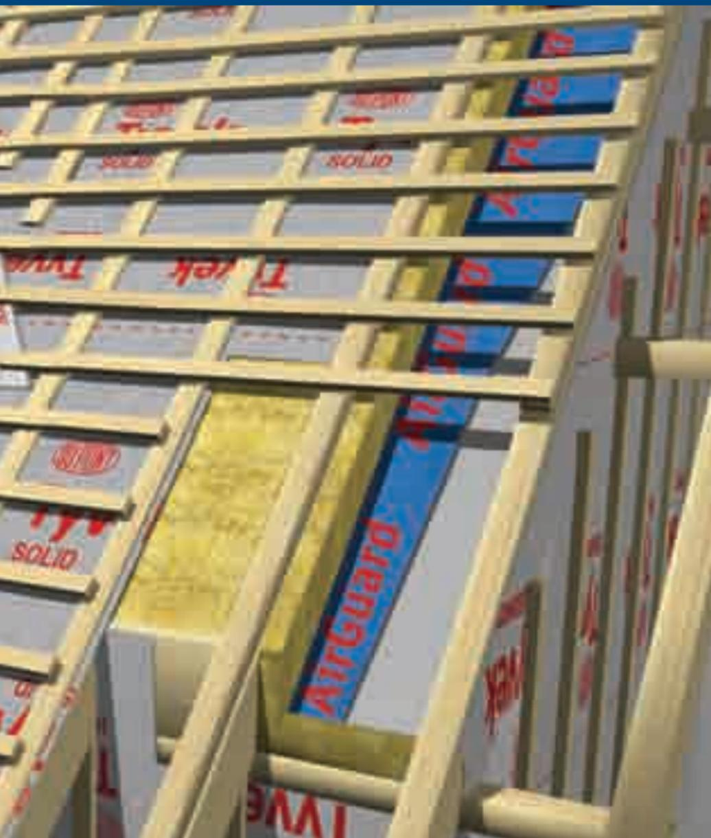
Материал Tyvek® Soft допускается устанавливать любой стороной. Tyvek® Solid, Tyvek® Solid Silver и Tyvek® Supro рекомендуется монтировать белой (без маркировки) стороной внутрь.
