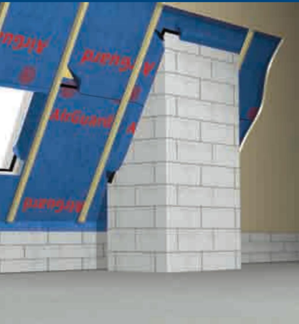
обязательна проклейка лентами бутил-каучуковой или акриловой основе Tyvek® Acrylic Tape, Tyvek® Double-sided Tape, Tyvek® Butyl Tape. В случае разрыва полотна возможна проклейка аналогичными клейкими лентами.
