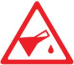
При химической обработке деревянных элементов конструкции применение материала Tyvek® допускается только после их полного просыхания, не ранее, чем через 24 часа после обработки.
