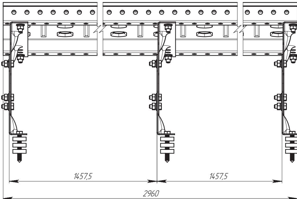
Угол наклона кронштейнов можно регулировать с шагом в 10-15° в пределах от 0° до 45°.
